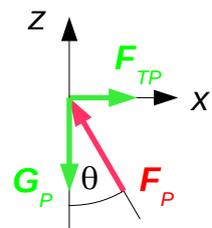
folgt, dass die Kraft  $F_P$  die gleiche Richtung wie die Auftriebskraft  $A$  hat.
