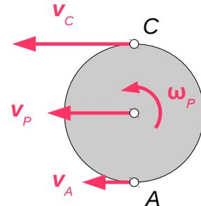
Im Punkt C ist das Planetenrad im Kontakt mit dem Hohlrad:  $v_C = r_H \omega_H$
