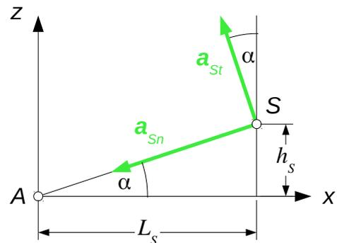
Die Kräfte im Lager A können mit dem Schwerpunktsatz berechnet werden:
