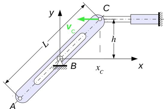
Verwenden Sie zur Lösung die geometrischen Beziehungen und überprüfen Sie das Ergebnis mithilfe des Momentanpols des Trägers  $AC$ .
