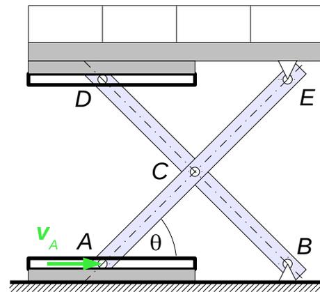
Bestimmen Sie die Abhängigkeit der Geschwindigkeit  $v$ , mit der sich die Bühne hebt, vom Winkel  $\theta$  und der Geschwindigkeit  $v_A$  aus den geometrischen Beziehungen.
