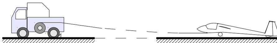
Das Segelflugzeug mit der Masse  $m$  soll beim Windenstart mit der Beschleunigung  $a$  beschleunigt werden. Es kann angenommen werden, dass die Seilkraft in horizontaler Richtung am Flugzeug angreift.
