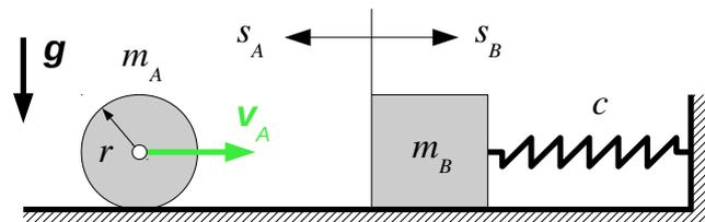
Der Reibungskoeffizient zwischen Klotz und Boden und zwischen Kugel und Boden ist  $\mu$ . Die Reibung zwischen Kugel und Klotz während des Stoßes darf vernachlässigt werden.
