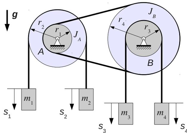
Über den inneren Umfang der Rolle B verläuft ein dehnscharres Seil, an dem die Massen  $m_3$  und  $m_4$  befestigt sind.
