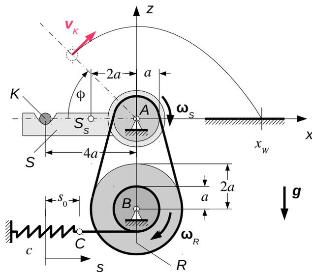
starres Seil aufgespult, das im Punkt C mit einer Feder (Federkonstante  $c$ ) verbunden ist. In der dargestellten Ruhelage hat die Feder die Auslenkung  $s_0$ .
