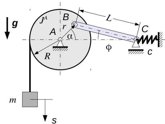
Auf der Rolle ist ein masseloses dehnstarres Seil aufgewickelt, an dem die Masse  $m$  befestigt ist.
