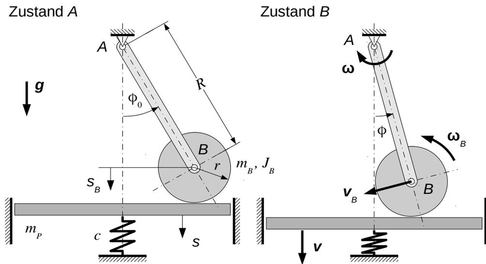
Die starre masselose Stange  $AB$  ist im Punkt  $A$  reibungsfrei gelenkig gelagert. Im Punkt  $B$  ist eine Rolle (Masse  $m_B$ , Massenträgheitsmoment  $J_B$  bezüglich Punkt  $B$ ) reibungsfrei gelenkig angeschlossen, die auf einer starren Platte (Masse  $m_P$ ) rollt. Die Platte wird reibungsfrei so geführt, dass sie sich nur in vertikaler Richtung bewegen kann. An der Platte ist eine lineare Feder (Federkonstante  $c$ ) angeschlossen.
