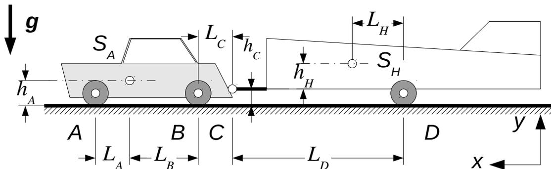
Ein PKW der Masse  $m_A$  mit Vorderradantrieb zieht einen Segelflugzeuganhänger der Masse  $m_H$ . Der Anhänger ist in der Kupplung C gelenkig an den PKW angeschlossen.
