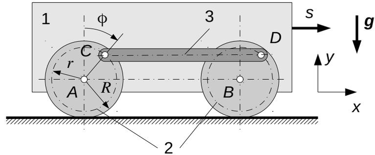
reibungsfrei gelenkig angeschlossen ist. An die Räder auf beiden Seiten ist in den Punkten C und D jeweils eine starre Stange (Masse  $m_3$ ) reibungsfrei gelenkig angeschlossen. Die Punkte C und D haben jeweils den Abstand  $r$  vom Radmittelpunkt.
