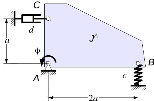
Die Auslenkung des Körpers wird durch den im Gegenuhrzeigersinn positiv gemessenen Winkel  $\phi$  beschrieben, der als klein angenommen werden darf. Eine Messung ergibt, dass während der Beobachtungszeit  $T_B$  insgesamt  $N$  volle Schwingungen ausgeführt werden. Dabei geht die Amplitude des Winkels von  $\phi_0 = \phi(0)$  auf  $\phi_N = \phi(T_B)$  zurück.
