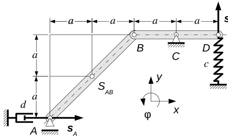
Stange BD im Punkt C durch ein Festlager gehalten. Im Punkt A ist ein linearer Dämpfer mit der Dämpferkonstanten  $d$  und im Punkt D eine lineare Feder mit der Federkonstanten  $c$  angeschlossen.
