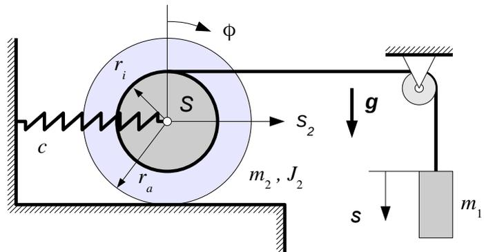
Die Wege  $s$  und  $s_2$  sowie der Winkel  $\phi$  werden ab der Ausgangslage gemessen, in der die Feder entspannt ist.
