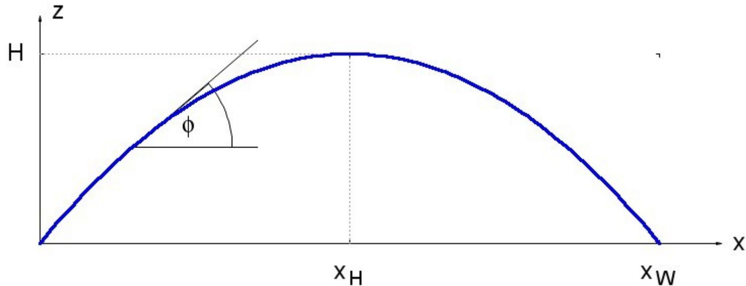
$H$ : Wurfhöhe,  $x_W$ : Wurfweite,  $\phi$ : Bahnwinkel
