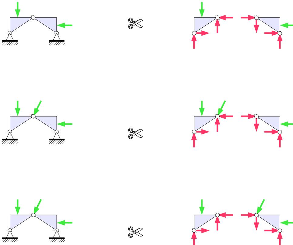
An den beiden Schnittpunkten sind entgegengesetzt gleich große Gelenkkräfte einzuzeichnen. Beim Zusammenbau müssen sich die Kräfte aufheben.
